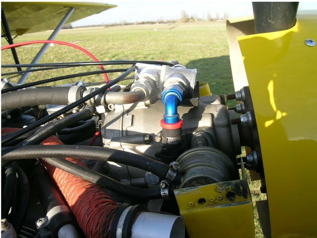
Le plus difficile dans ce montage est la mise en place de la durit d'huile sur les raccords.
